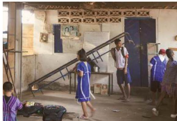
der Einfahrt. Die vorhandenen Klassenräume bestehen aus Betonskelettbauweisen, welche das Dach halten, und etwa 1,50 m hohen Betonwänden als Sekundärstruktur. Somit entsteht ein großzügiger Abstand zum Dach, der die Luftzirkulation fördert. Die Größe der Klassenräume variiert je nach Alter. Große Mengen an Abfall prägen das Bild und die bestehenden Toilettenanlagen sind in Anbetracht der Hygiene ausbaufähig.
